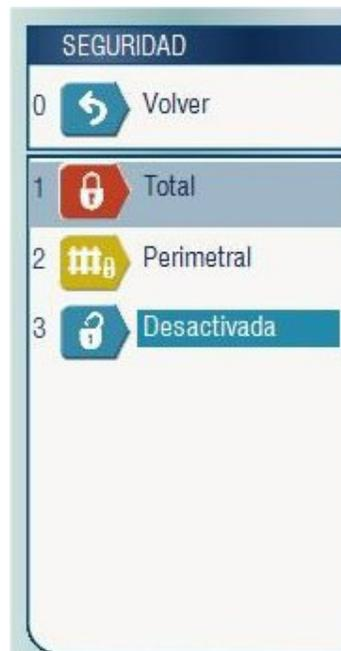
Para acceder a los distintos modos de funcionamiento de seguridad, pulsaremos el número que corresponda. También podremos cambiar los modos de alarma si estamos autorizados mediante SMS, minimandos o teclados de alarma, programaciones horarias o por eventos.
