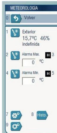
Tal y como se puede apreciar, podremos a cada sensor de temperatura en concreto establecer un valor máximo y mínimo de temperatura, para ello introduciremos el valor y pulsaremos en la “H” para habilitar dicha alarma. Una vez realizado esto cuando vayamos a la pantalla principal ya nos indicara con “max” o “min” indicándonos que tenemos esa alarma habilitada y cuando supere dichos valores nos cambiara a color rojo y emitirá una indicación acústica.
